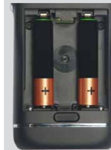
Batteriefach mit Batterien
